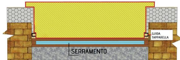
Lithopor mod. 4: Davanzale con alette e con alloggi per guide tapparelle
